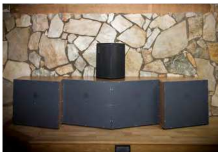
oben: Messung eines AVAA im Regieraum unten: AVAA auf vier konventionellen Bassfallen
