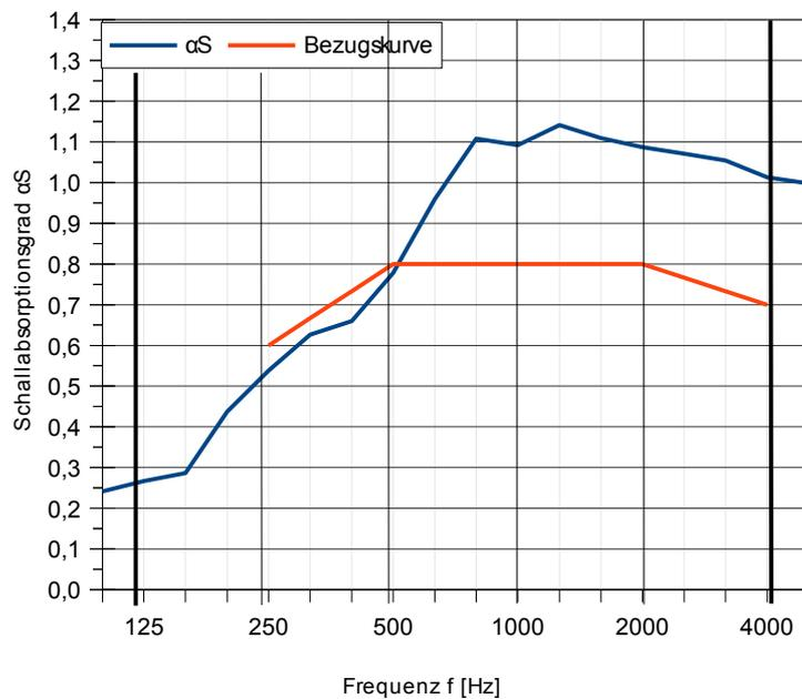
$\alpha_S$ : Schallabsorptionsgrad nach DIN EN ISO 354
